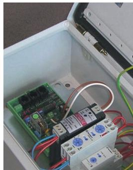
Steuerung inkl. Schneesensor zu Glasheizung (siehe oben). Schaltet das Heizglas in Abhängigkeit mit Schmelzwasser/Schnee ein/aus. Muss horizontal neben der Abdeckung montiert werden.
